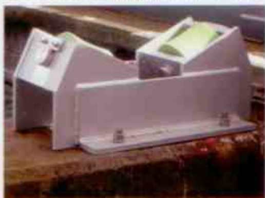
Petrobras - Roletes em Plástico de Alta Performance (RPAPI®) instalados nos pieres
